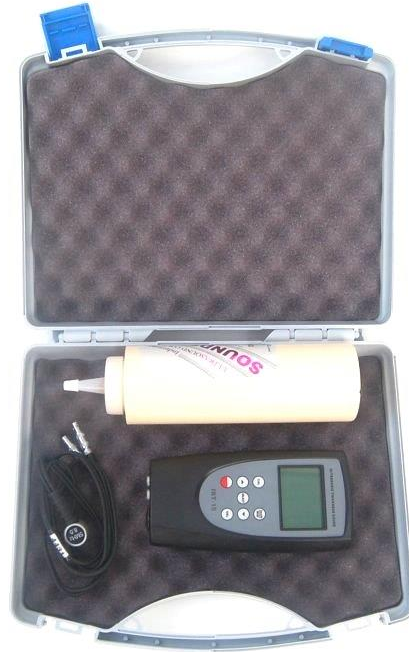
IBT-15 set in iets grotere koffer met fles koppelmiddel
